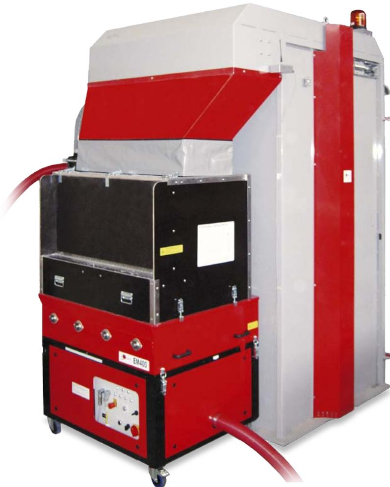
Die Großballenfräse **GBF 1050** ist eine Maschine zur Verarbeitung von zu Großballen verpressten Dämmstoffen. Der verpresste Dämmstoff wird aufgelockert und über einen Auswurf in die Einblasmaschine gefördert. Die Großballenfräse verfügt über eine Füllstandsmessung: Sobald der Aufgabeebehälter der Einblasmaschine gefüllt ist, wird der Auflockerungsprozess unterbrochen.
